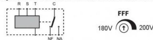
Modelo falta de fase: funcionamento independente da sequencia de fase (sem neutro).
